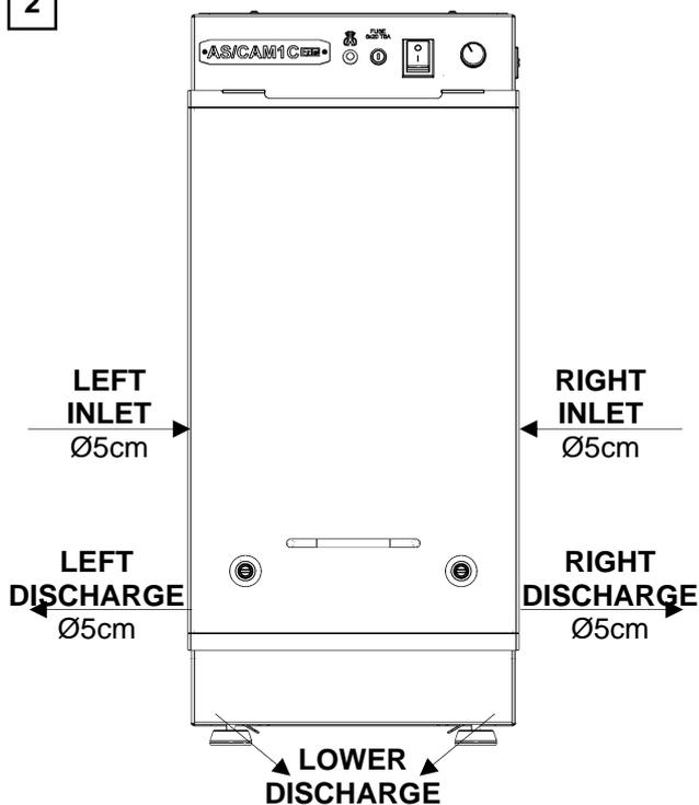
L'aspiratore AS/CAM1C permette di avere l'aspirazione a destra o a sinistra e lo scarico inferiore a destra o a sinistra .
